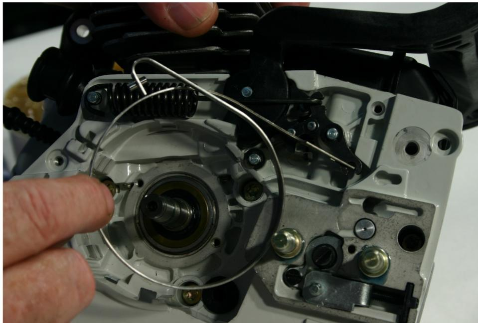
**67.) Montieren Sie das Bremsband.**
