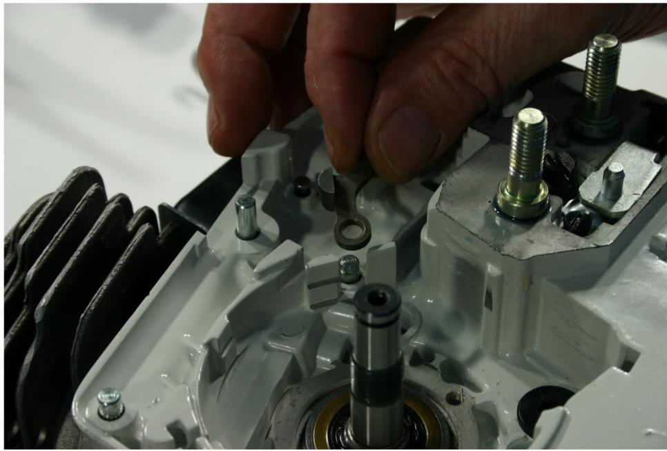
**61.) Montieren Sie die den unteren Hebel der Kettenbremse.**
