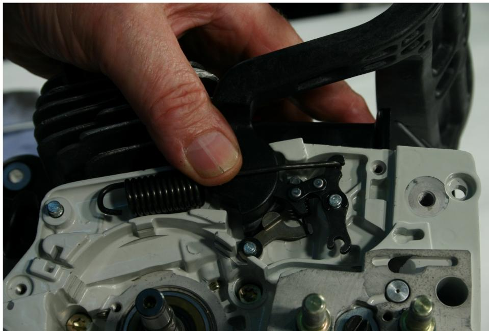
**65.) Montieren Sie die Zugfeder.**
